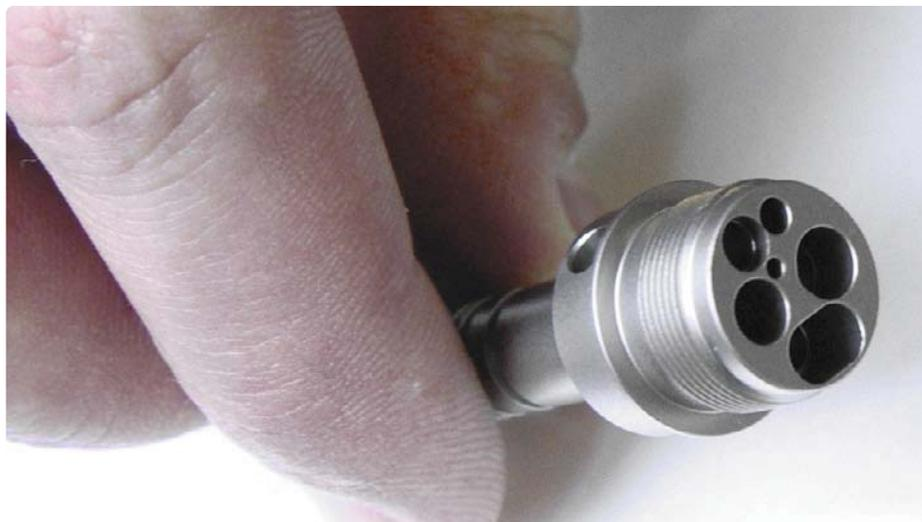
Dans ce boîtier de soupape en acier au chrome, plusieurs petits perçages affleurant exactement le manteau de cylindre et dont la profondeur va jusqu'à 16 x D sont réalisés.
