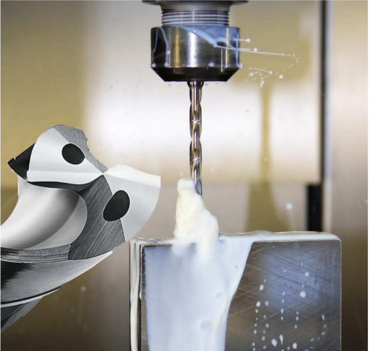
In zäharten und korrosionsfesten Stählen und Titan bis 30 D prozessicher, produktiv und genau bohren mit den optimierten VHM-Hochleistungsbohrern Phoenix TC2 der Sphinx Werkzeuge AG.
