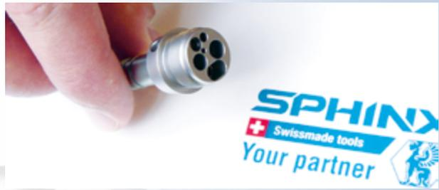
In die Ventilgehäuse aus Chromstahl sind mehrere kleine, zum Teil bis 16×D tiefe, gegen den Zylindermantel exakt fluchtende Bohrungen einzubringen
