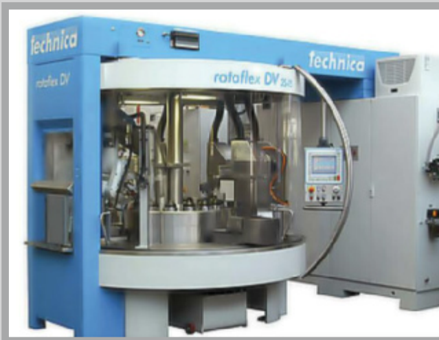
Bild 2. Rundtransfermaschine ›Rotaflex DV‹. Diese Maschinen sind mit jeweils 14 CNC-Bearbeitungseinheiten ausgestattet, die wie kleine Bearbeitungszentren konzipiert sind
