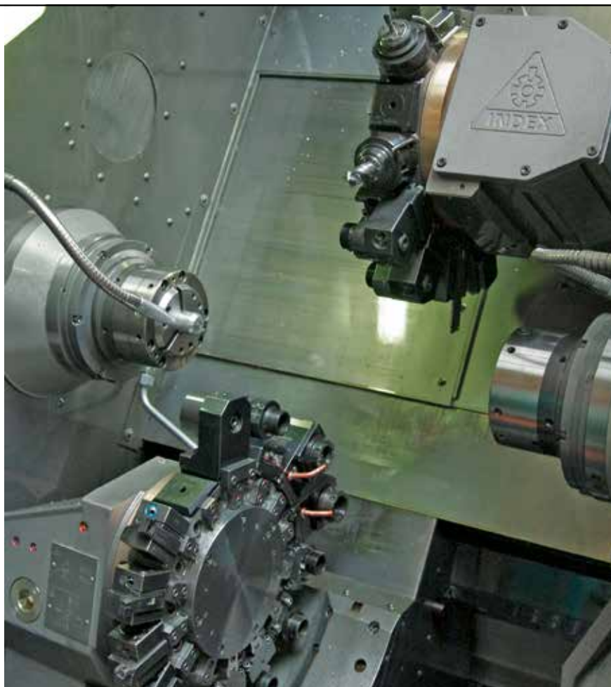
2 Viele Plätze, großer Aufwand: Die unterschiedlichen Bohr-, Dreh- und Fräswerkzeuge zur Komplettbearbeitung sorgfältig zu rüsten und zu justieren verursachte bei dem Präzisionsfertiger aus Waldenburg immer wieder unwirtschaftlich lange Nebenzeiten (© Mücke)
